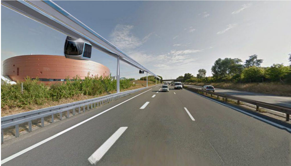
Le bas des navettes serait à 1,50 m au-dessus des camions. © Supraways
